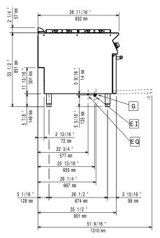
Electrical inlet (power) Equipotential screw Gas connection
